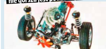
Za rozdział napędu w 325ix odpowiada sprzęgło wiskotyczne.
